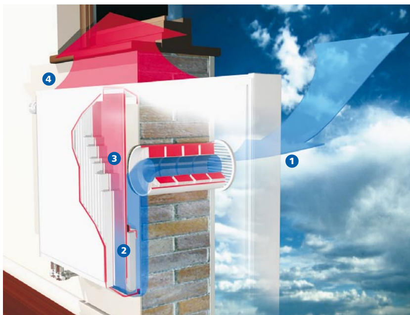
Funkční princip systému ComfortAir
